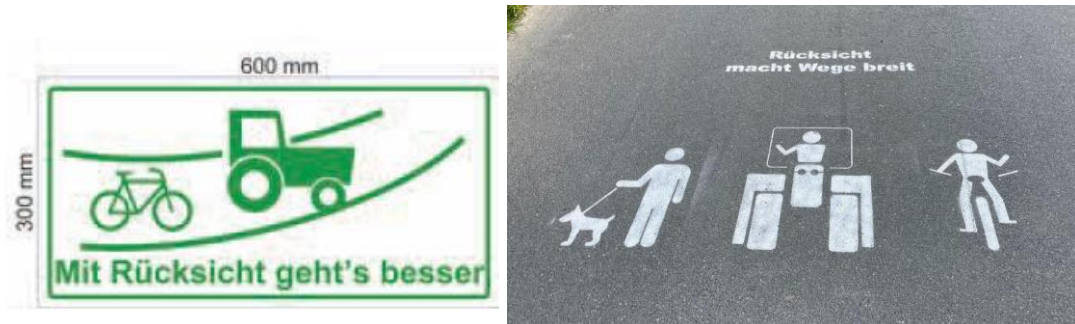
Abbildung 14: Kleines Zusatzschild, Beispiel aus den HBR 2014 (Hinweise zur wegweisenden und touristischen Beschilderung für den Radverkehr in Rheinland-Pfalz) und Beispiel für Bodenmarkierung aus Ober-Ramstadt (Quelle: R+T)
